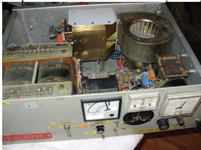
Ampli 23cm ATV à tube 2 x 2c39 (120 w )
